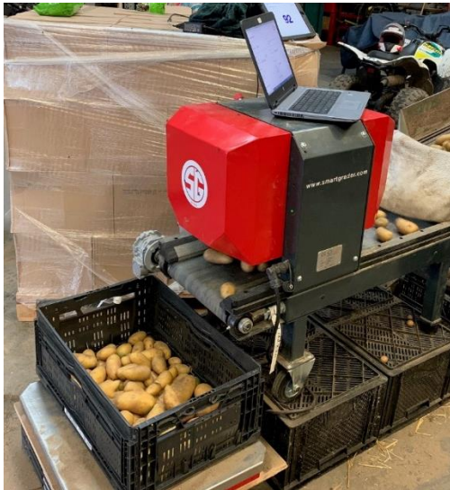
Afbeelding 4. Met de Smart Reader wordt van elke knol optisch geteld en de maat gescand, vervolgens wordt het gewicht van de partij bepaald. De Smart Reader rekent deze data om in een aantal knollen en gewicht in door de gebruiker in te stellen grootte-classes (bv. <28mm, 28-35mm, 35-45mm, 45-60mm en >60mm).
